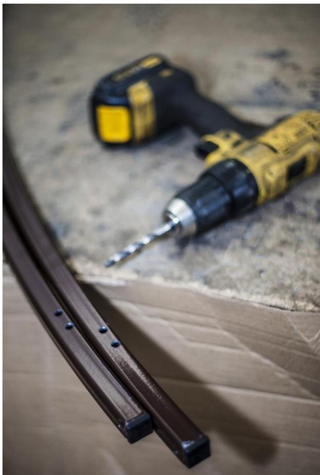
Просверлить в каждой арке по 4 отверстия диаметром 7-8мм согласно предварительной разметке.
